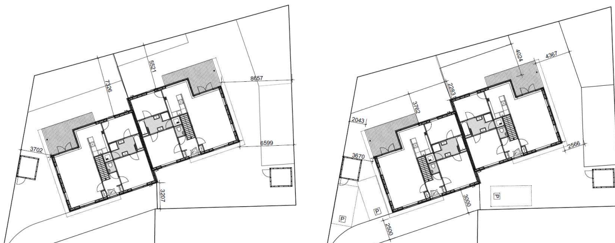
Afbeelding: situatietekening nieuwe situatie voorzien van afstanden tot oorspronkelijke en nieuwe erfgrenzen
