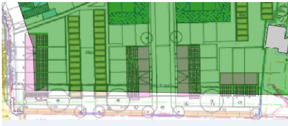
Afbeelding 4: overschrijding bouwvlak (bouwvlak is in groen aangegeven)
